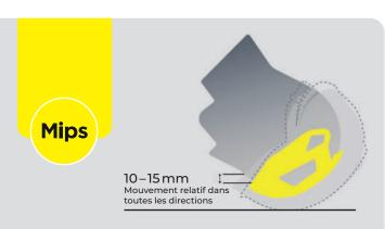
MIPS est une couche à faible friction à l'intérieur du casque. Ce système a pour but de réduire la force de rotation de la tête transmise au cerveau lors d'un choc. Il permet un mouvement libre omnidirectionnel de 10-15 mm entre le casque et la tête. Le système de protection cérébrale MIPS est une solution suédoise brevetée qui se fonde sur plus de 20 années d'études réalisées par les bio-ingénieurs et chercheurs à l'institut Karolinska et à l'institut royal technologique.
